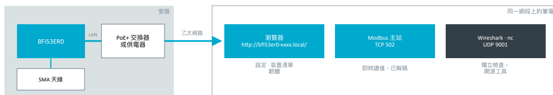
圖 3：首次安裝：閘道、PoE+ 交換器與筆電位於同一網段
