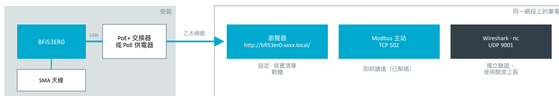
圖 2：首次安裝：閘道、PoE+ 交換器，以及同一網段上的筆電
