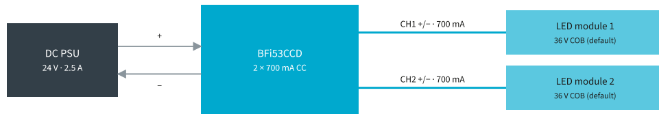
圖 2：雙通道定電流 配線
